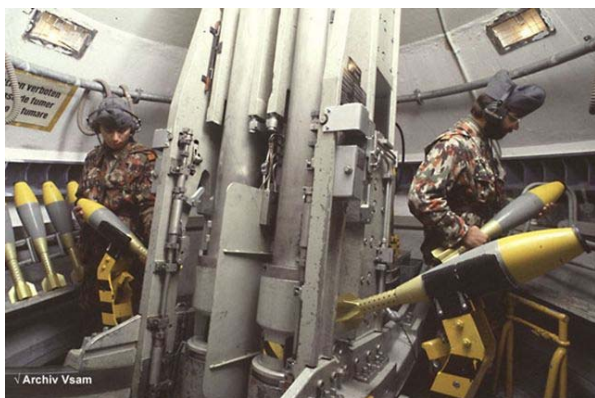
Panzerkuppel eines 12 cm Fst Mw 59/83. Die Minen werden mit den Ladungen auf Ladearme gelegt und eingeschwenkt, die Verschlüsse der beiden Rohre arbeiten automatisch. Kadenz: 16 Schuss pro Minute
