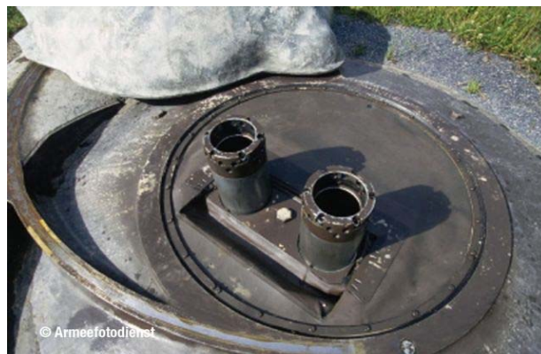
Wenn die Hydraulik den Deckel zur Seite schiebt und die Rohre ausgefahren sind, gibt es im Umkreis von 17 Kilometern für einen Angreifer keine Deckung.
